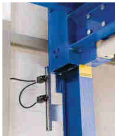
Contacts en gaine précâblés avec connecteurs
